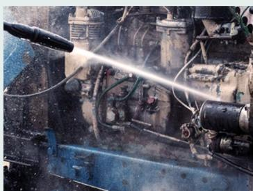
Com uma lavadora de alta pressão, remova todos os resíduos de graxa, óleo e lubrificantes que estiverem espalhados pelo equipamento.
